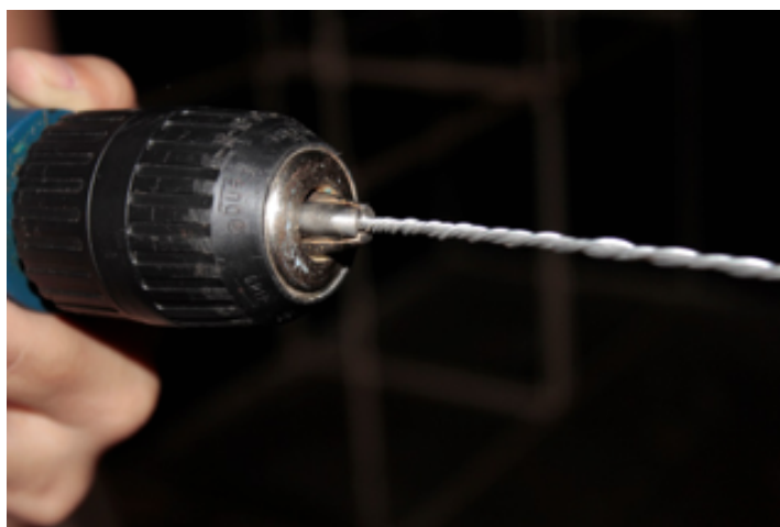
Figura 1: Sistema de enrolamento do arame de alumínio para construção dos esqueletos
